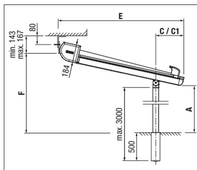
Montage sous dalle avec douilles de sol
